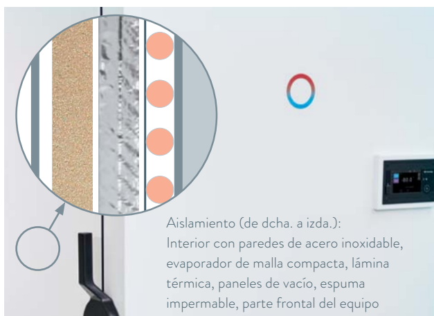
Tecnología de aislamiento de alto rendimiento con materiales de alta calidad
