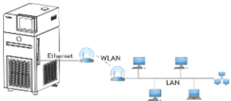
Fig. 14: Conexión a través de LAN y WLAN
