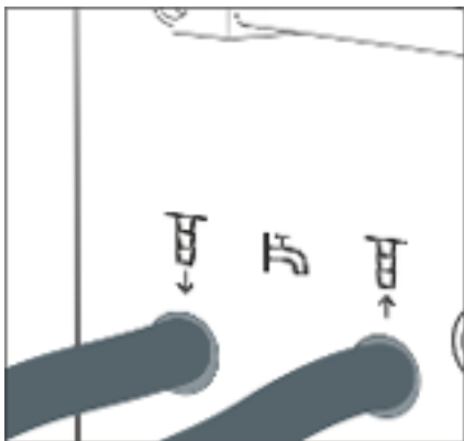
Fig. 21: Entrada y salida de agua de refrigeración
