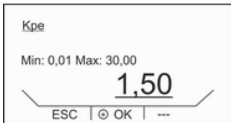
Abb. 57: Regelparameter Kpe anpassen
