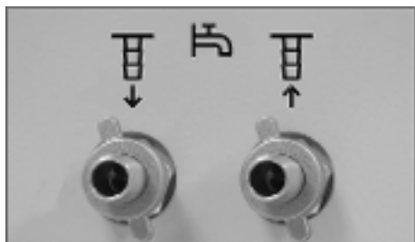
Abb. 64: Gegenmuttern auf den Kühlwasserstutzen
